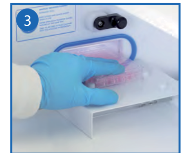
Nun legen Sie die Zellkulturware in den Tunnel, machen die Tür zu und schließen sie ab.
