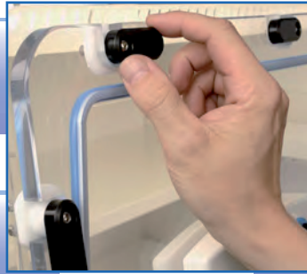
Optionale leicht abnehmbare Frontscheibe zum Einbringen von Gegenständen und Proben, sowie zur Reinigung.
