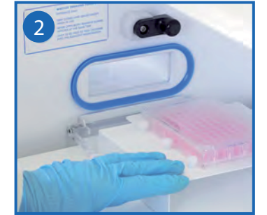
Platzieren Sie die einzuführende Zellkulturware auf einer Halterung.
